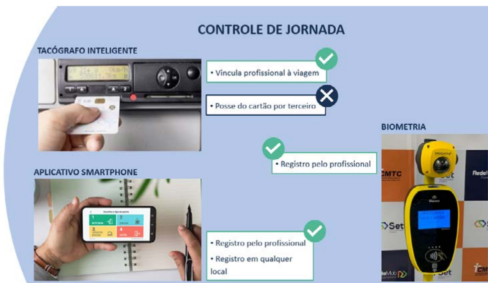
Figura 11: Opções de tecnologias para controle de jornada de trabalho do motorista e cobrador
