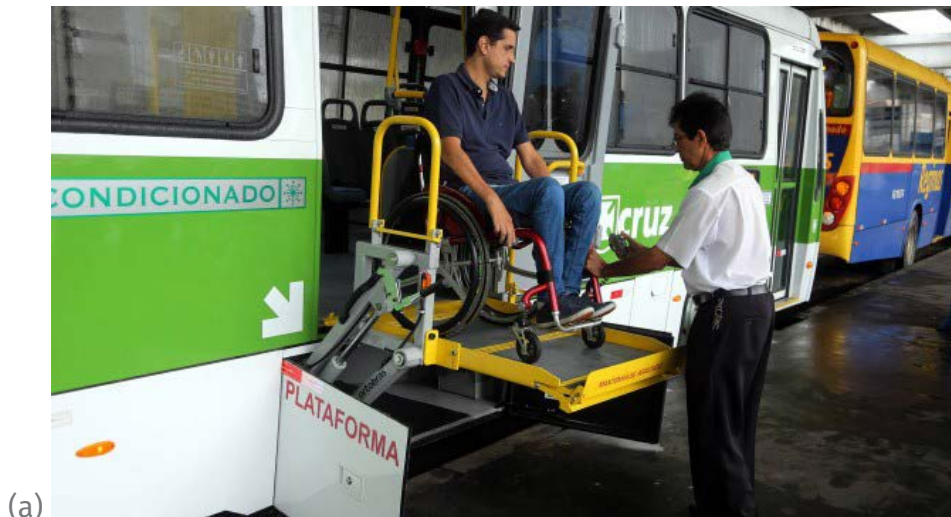
Figura 9: Tecnologias de acessibilidade no transporte coletivo – (a) ônibus de piso alto com elevador para cadeirantes; (b) piso alto com embarque em nível; (c) ônibus de piso baixo
